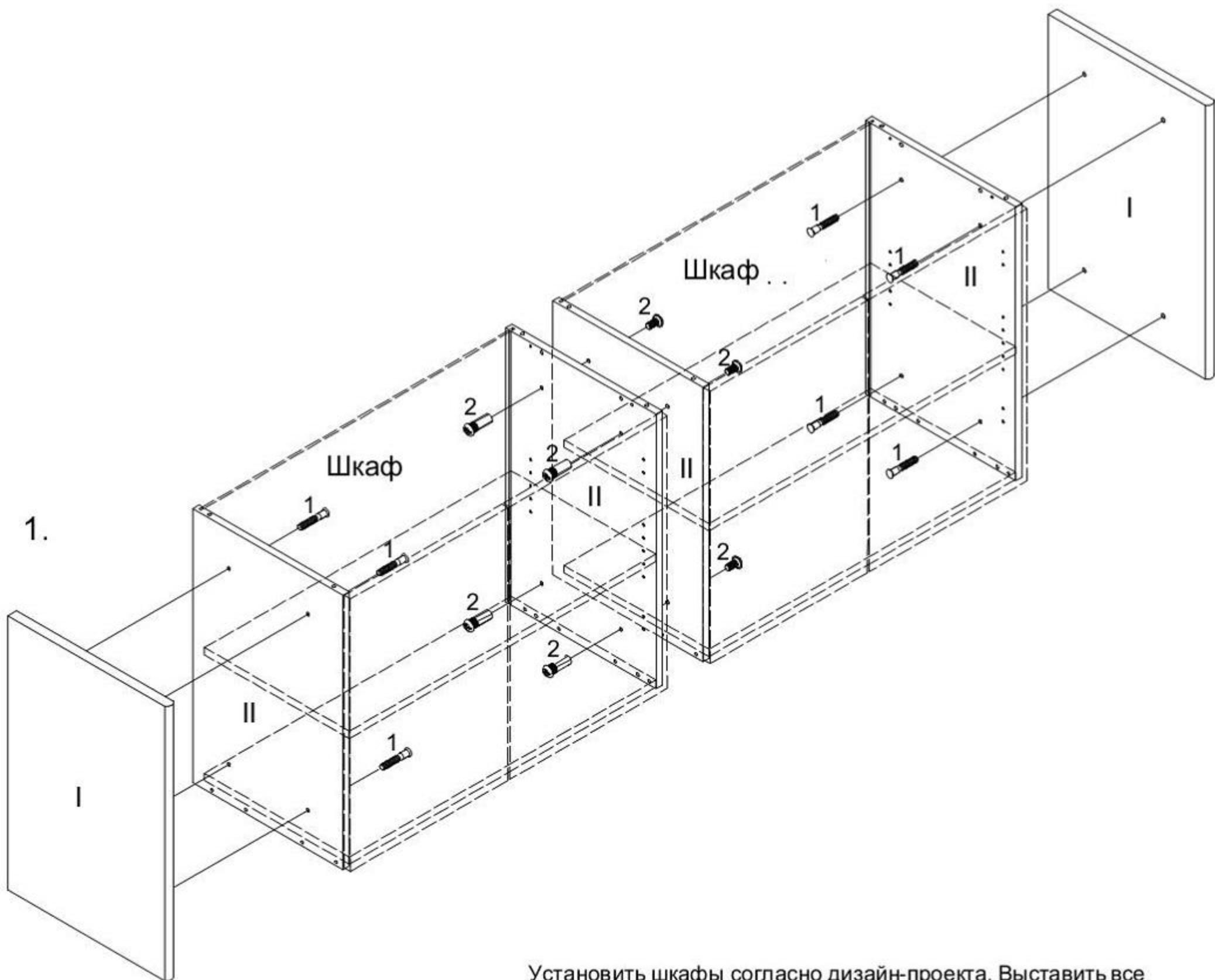
Установить шкафы согласно дизайн-проекта. Выставить все шкафы секции на одном уровне, регулируя опоры ключом шестигранным (смотри схемы сборки шкафов). Стянуть шкафы между собой межсекционными стяжками (2) через сквозные отверстия в боковинах (см.рис.1).
